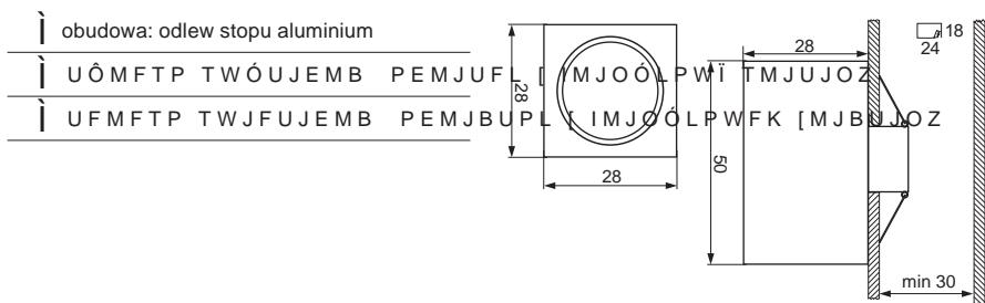
obudowa: odlew stopu aluminium
