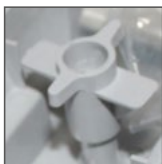
mocowanie blachy do obudowy za pomocą „motylka”
