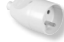
GN-171 Gniazdo przenośne 16A, 250V, 2P+Z
