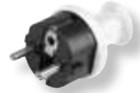
WT-40 H Wtyczka rozbieralna Uni Schuko IP 44 16A, 250V, 2P+Z
